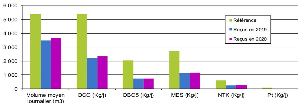
Pour 2020, le ratio DCO/DBO moyen est de 3,2 en comparaison à un ratio des stations nationales et une valeur nominale respectivement de 2,5 et 2,7. La biodégradabilité de l'effluent en entrée de la station est donc moins bonne que la valeur attendue.
